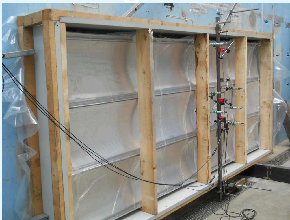
Fotografia del campione durante la prova di resistenza al carico statico uniformemente distribuito in depressione.
