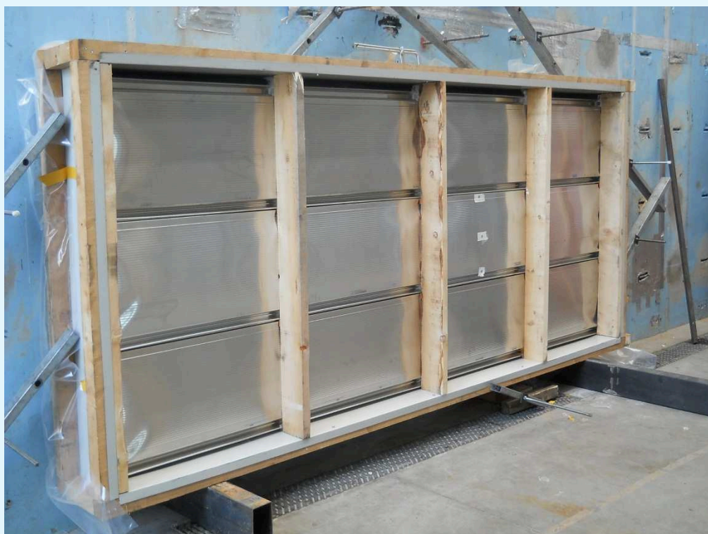
Fotografia del campione durante la prova di resistenza al carico statico uniformemente distribuito in pressione.
