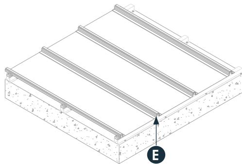
PARTENZA DELLA LASTRA SUCCESSIVA FISSATA A PEDATA (SU MASCHIO PRECEDENTEMENTE INSTALLATO TRAMITE **dRAIN\_FIX**) E RIPETIZIONE PUNTO **D** FINO A FINE COPERTURA.
