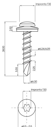
Vite autoperforante zincata con trattamento isolante anti corrosivo
