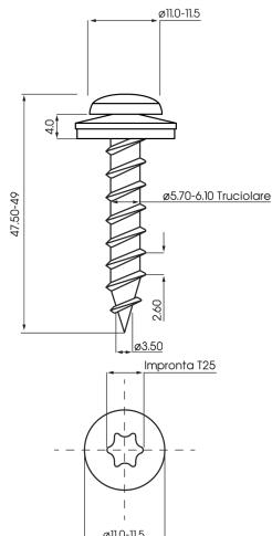
Vite in acciaio inox truciolare in legno
