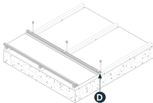
FISSAGGIO COMPLESSIVO DELLA LASTRA TRAMITE STAFFA **dRAIN\_FIX**, AVVITATA AL PROFILO OMEGA SOTTOSTANTE;
