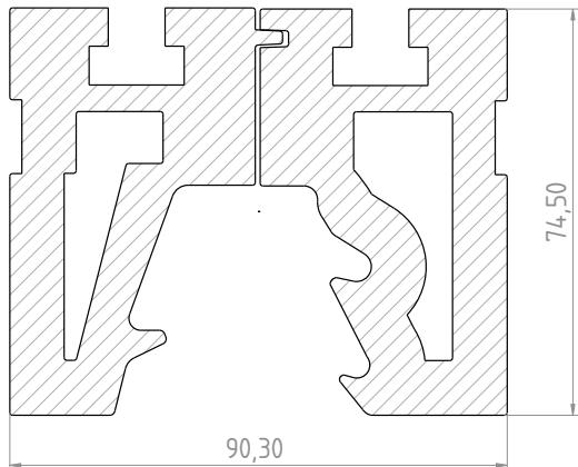
**dRain\_Block SEC** è stato testato ai carichi verticali e longitudinali, in elemento singolo ed accoppiato. I migliori produttori di sistemi anti caduta hanno testato il proprio sistema di linea vita su copertura **Mela\_dRain**.
